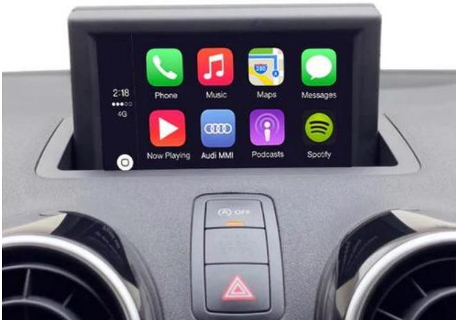
Met deze update blijft het originele systeem gewoon bruikbaar zoals je gewend bent. Het systeem gebruikt je originele radio en scherm. Je kunt dus alle luidsprekers en de originele microfoon blijven gebruiken. Ook zijn de CarPlay en Andriod Auto te bedienen met de bestaande knoppen aan het stuur en touchscreen of knop, gewoon zoals origineel.
